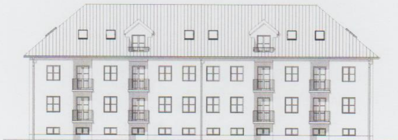
Vestfacade med nye altaner - samtlige blokke
